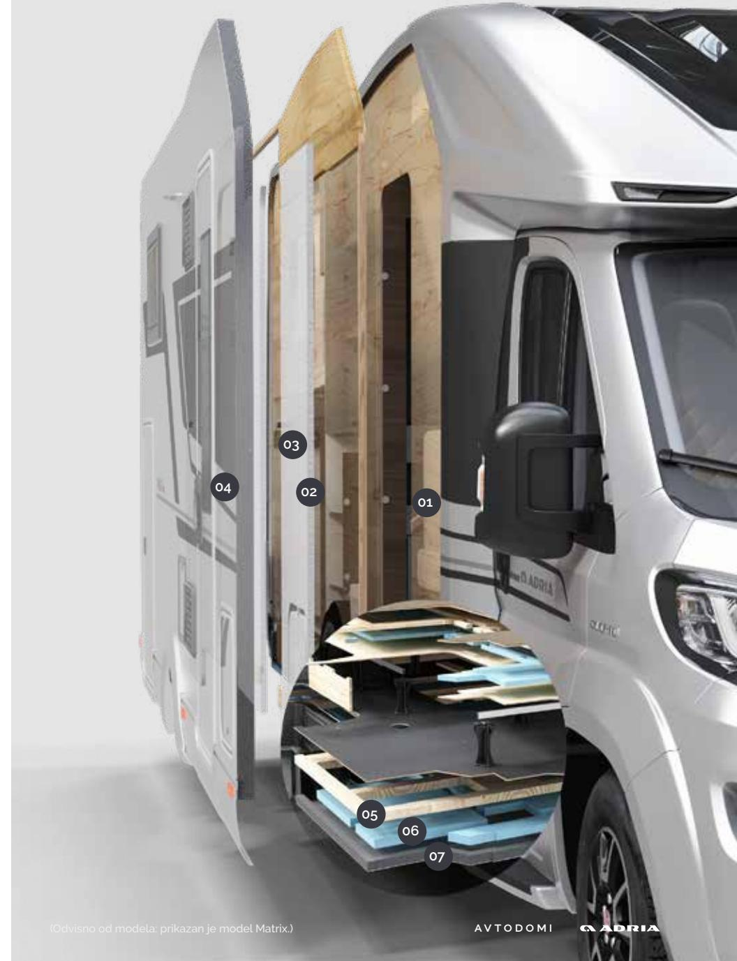
Vsi avtodomi imajo **dvojni pod** v eni višini v celotnem vozilu in 13 cm prostora pod podom za vgrajene pripomočke, izolacijo in dodatno shranjevanje. Proti udarcem odporni **rezervoarji za pitno vodo** so nameščeni tako, da kar najbolje vplivajo na ravnotežje in vodljivost vozila, za dolgotrajno delovanje brez puščanja so oblikovani iz enega kosa, do njih pa je skozi dvojna tla enostavno dostopati.
